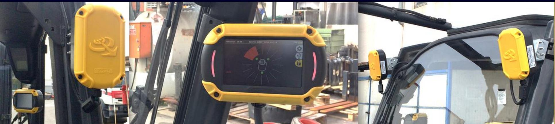
EGOPro Safe Move è un sistema di allarme e avviso di prossimità per dispositivi mobili di movimentazione, che segnala tramite allarme visivo e sonoro, **la presenza e la posizione di pedoni e / o altre mezzi che operano intorno al veicolo**, diminuendo il rischio di collisione in tutti i casi di scarsa visibilità e in caso di disattenzione.
